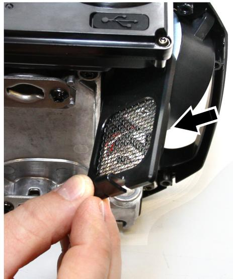
**Figure 12: Démontage du filtre**
